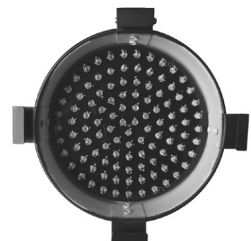
LED-Lampe; Einzeldioden mit Linsen
